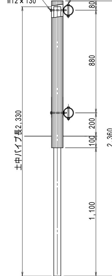
三次元継手金具詳細図
